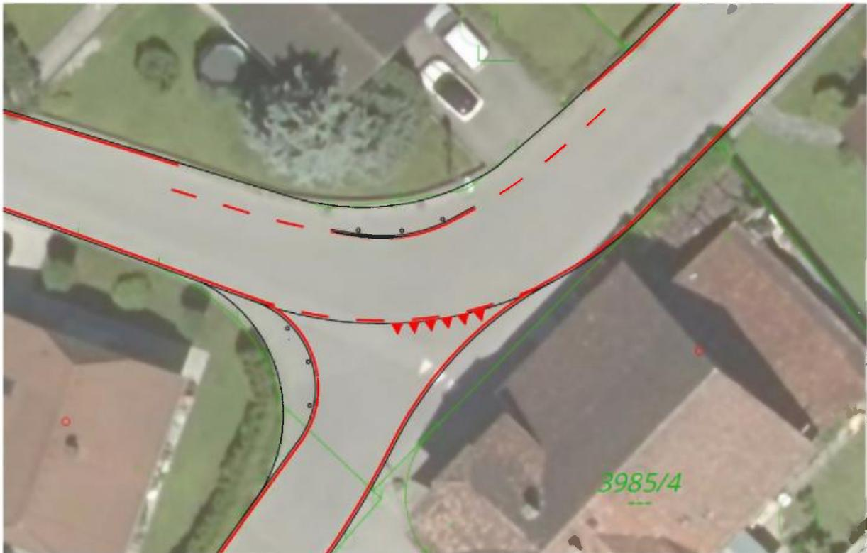
Abb. 14: Knotenverbesserung Fußverkehr
